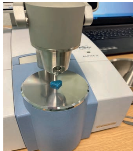
Abb.1: ATR-FT-IR der Fa. Bruker bei der Messung einer „Blue Punisher“-Tablette.
